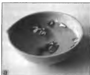
Мал. 72. Відношення магнію до води: а — холодної; б — гарячої. Утворення магній гідроксиду виявляє фенолфталеїн
